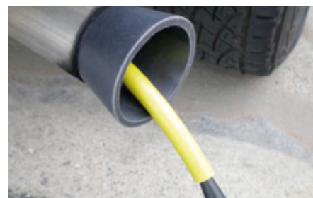
Le détecteur peut également détecter les fuites au niveau du système d'échappement
